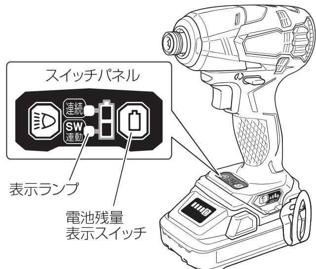
**注** ランプは蓄電池を工具本体に取付け、一度スイッチを引いた後でないと電池残量表示スイッチを押しても点灯しません。
